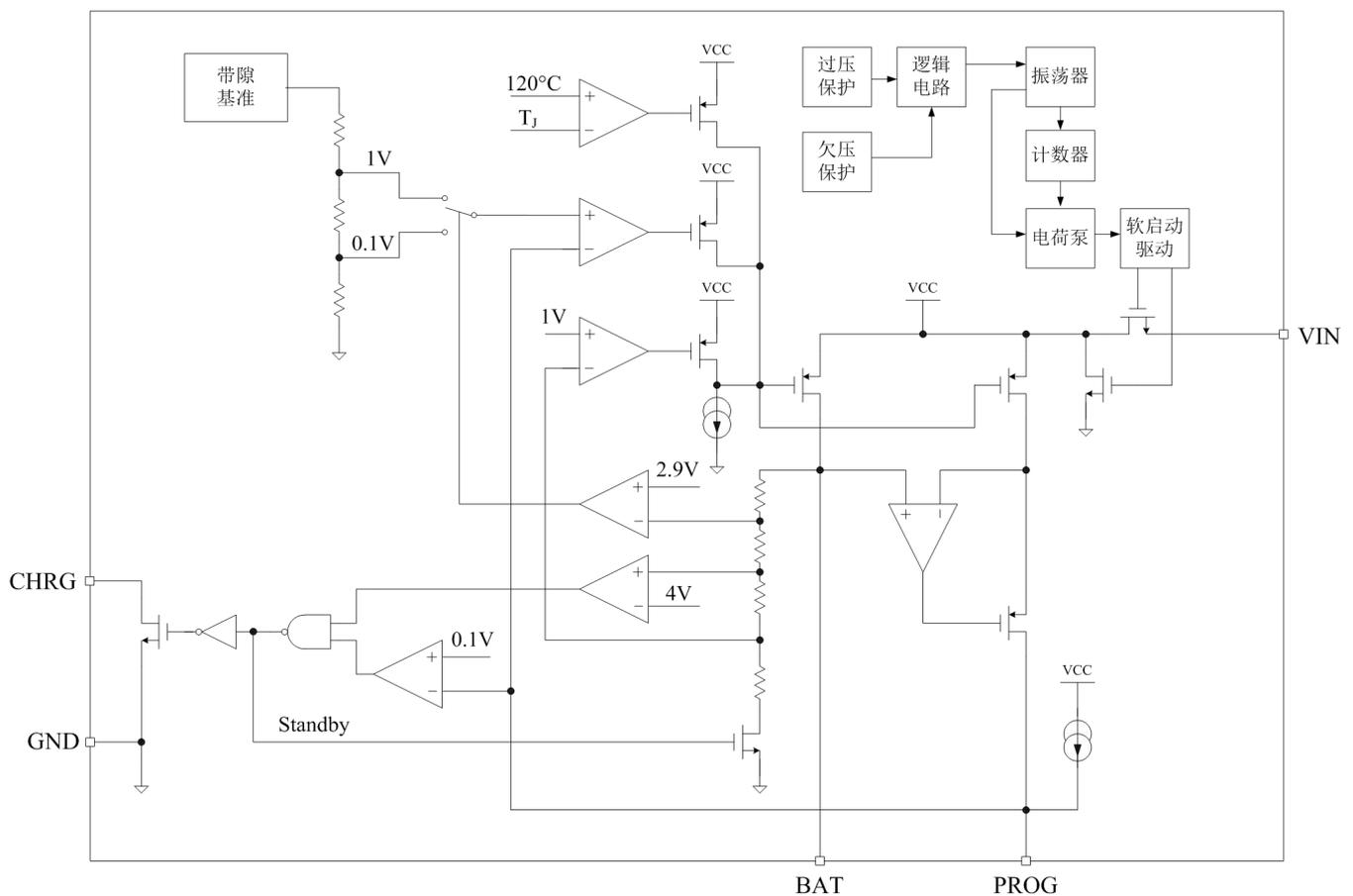
图 2: QX4058 的内部电路方框图
