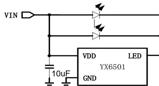
当输入电压大于4.2V, 输入端需要接10uF电容
